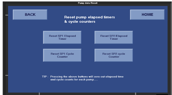
Tiempo de operación de bomba y Reinicio de conteo
